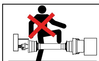
Ne pas utiliser la transmission en guise d'appui ou de marchepied.
