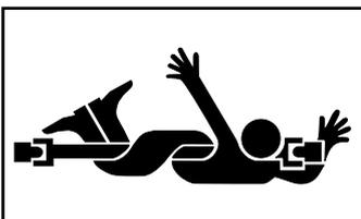
Ne pas s'approcher de la zone de travail ou de composants en rotation. Éviter de porter des vêtements de travail ou ceintures avec pans flottants, des écharpes, etc. **Le contact avec une pièce en rotation peut provoquer des accidents graves.**
