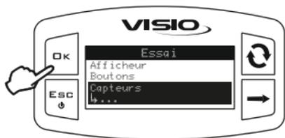
Accédez au menu du Essai des capteurs (*Menu principal > Essai > Capteurs*). Appuyez sur la touche **OK** pour accéder à la vérification.
