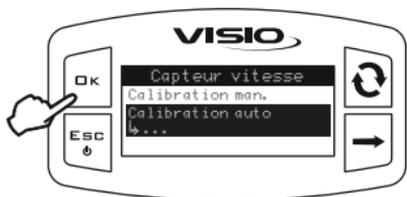
1) Accédez au menu de calibration automatique (*Menu principal > Capteurs > Capteur de vitesse > Calibration auto*).
