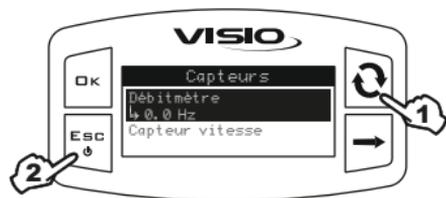
Sous la rubrique sélectionnée, l'écran affiche la valeur actuellement mesurée par le capteur.
