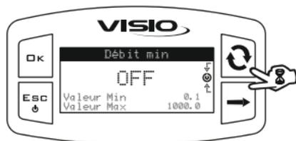
2) Pour activer l'alarme, appuyez sur les touches **OK** et **→** simultanément jusqu'à
