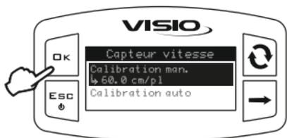
1) Accédez au menu de calibrage manuel (*Menu principal > Capteurs > Capteur de vitesse > Calibration man.*).
