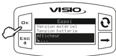
1) Accédez au menu du Essai de l'afficheur (*Menu principal > Essai > Afficheur*).
