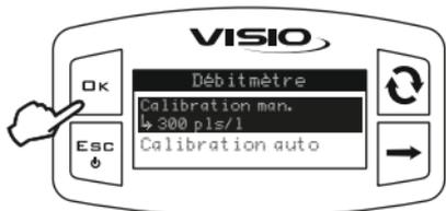
1) Accédez au menu de calibration manuel (**Menu principal > Capteurs > Débitmètre > Calibration man**)
