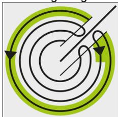
Dans ce mode de guidage, vous pouvez définir des traces pilotes circulaires pour traiter les champs qui sont équipés d'un système d'irrigation circulaire.
