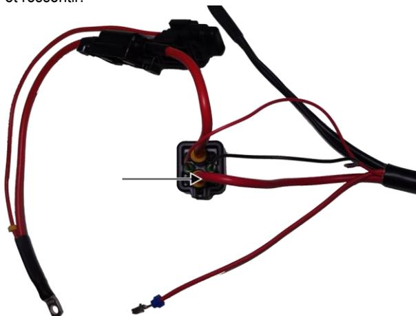
4. Branchez les fils rouge et noir de 0,5 mm<sup>2</sup> avec leur joint en caoutchouc dans l'emplacement de 0,5 mm<sup>2</sup> correspondant de l'embase du relais en orientant correctement la fiche. L'enclenchement du conducteur doit se faire clairement entendre et ressentir.
