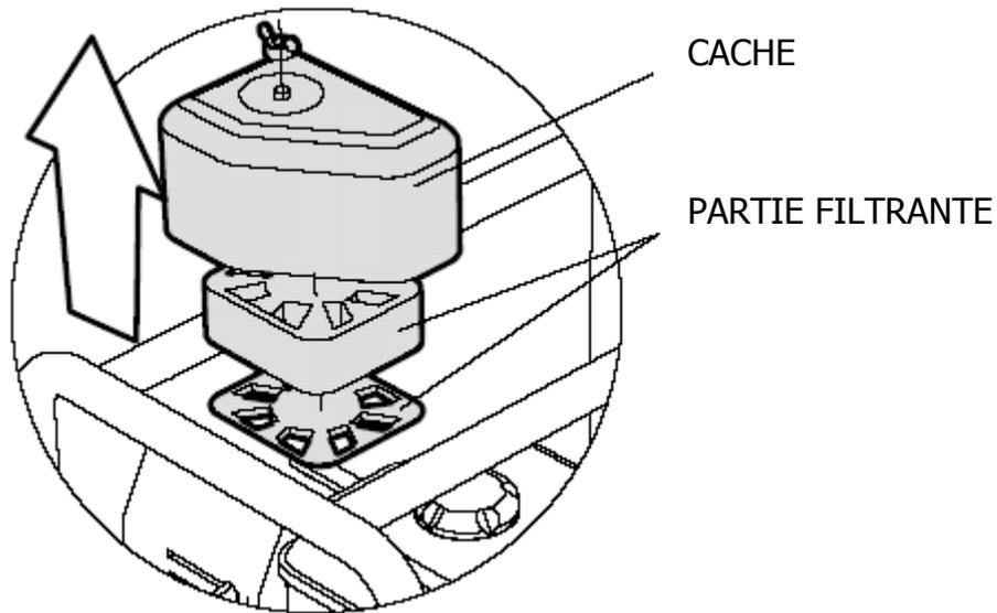
3-Nettoyer les divers composants avec une solution non inflammable et bien les laisser sécher après nettoyage
