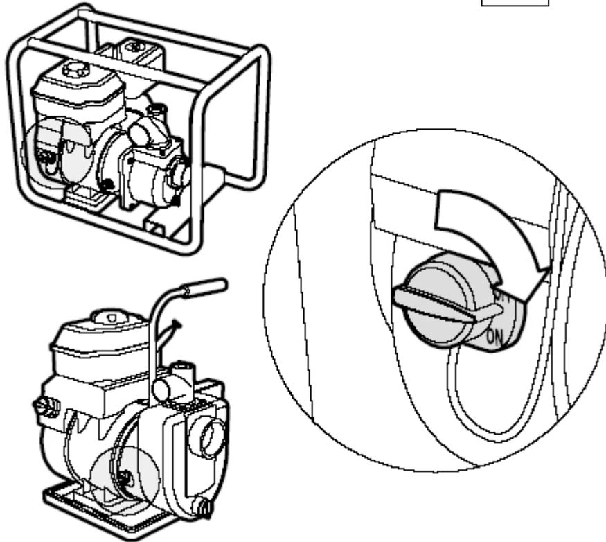
4-Tourner le levier de l'écrou à ailettes doucement vers la **GAUCHE**
