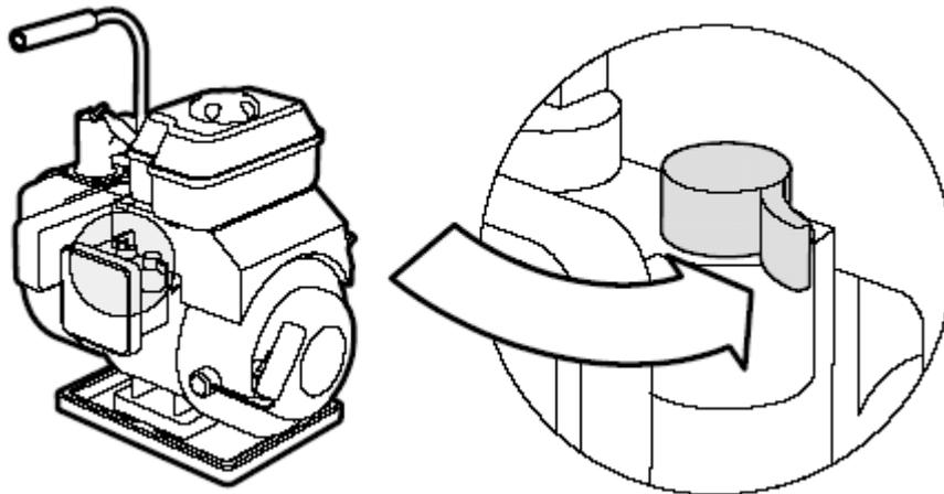
Remarque : lorsque le moteur est chaud ou que la température ambiante est élevée, il n'est pas nécessaire de maintenir le robinet ouvert au démarrage du moteur.
