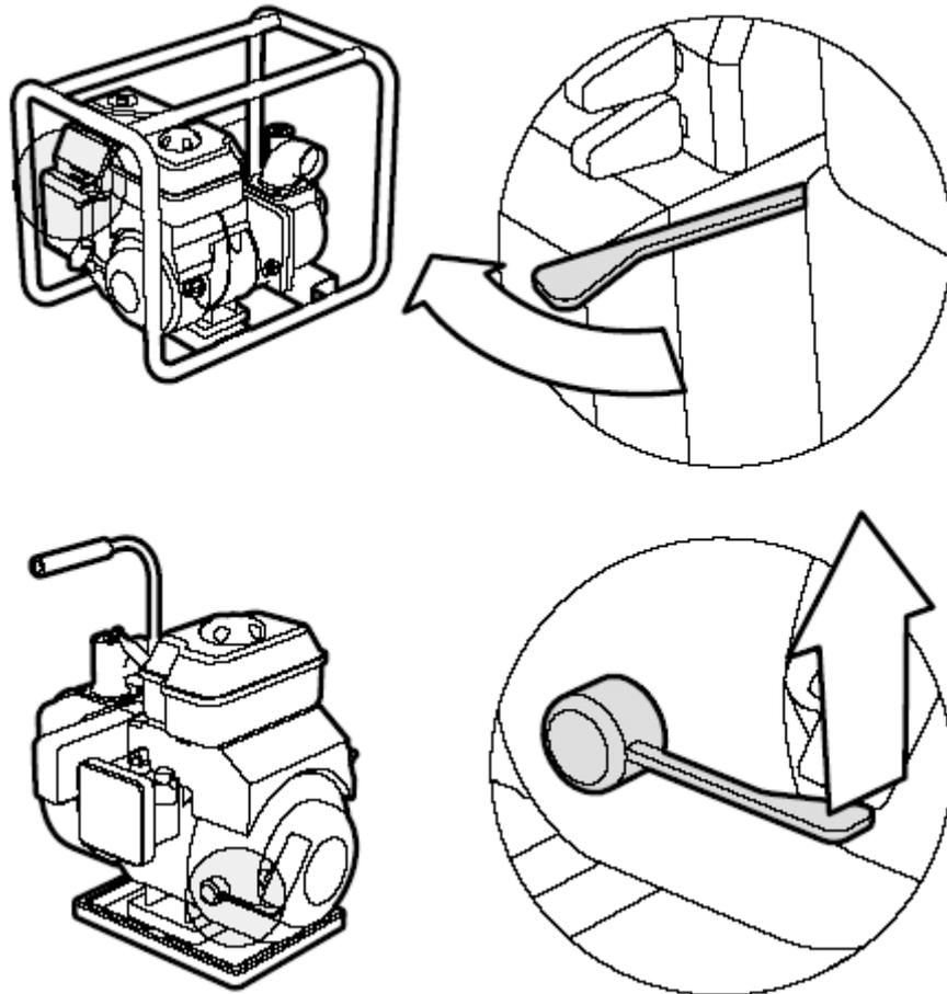
5-Remonter doucement le levier de démarrage jusqu'au point de résistance. A ce point lever le levier rapidement.
