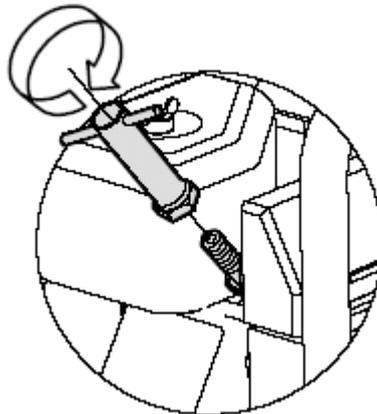
**ATTENTION** – Vérifier que la bougie de démarrage soit correctement vissée sans quoi le moteur pourrait surchauffer. Ne jamais utiliser de bougies d'une gamme thermique inadéquate.
