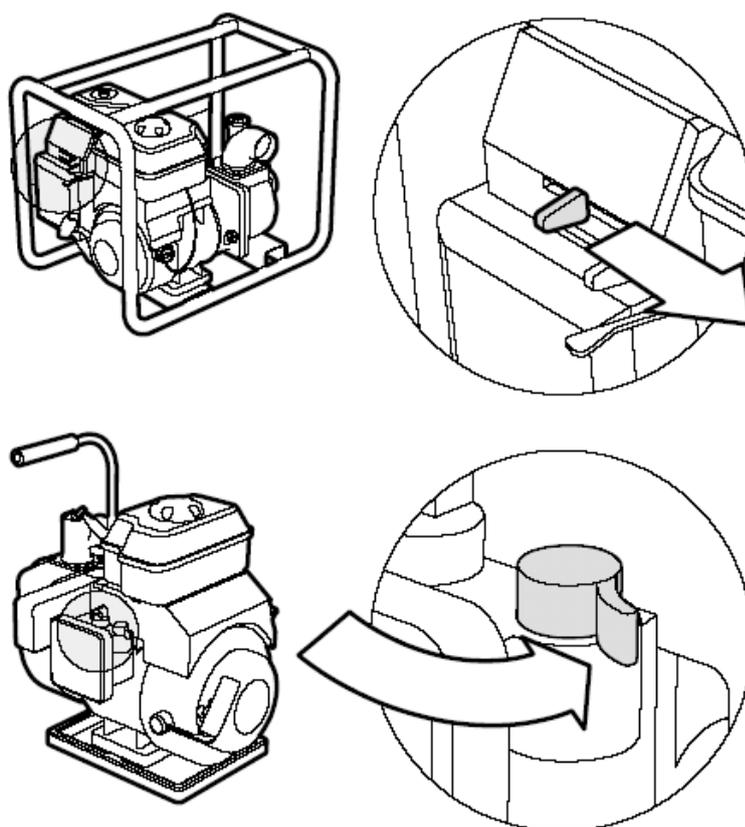
2-Placer le levier à ailettes sur le rpm prédéterminé.
