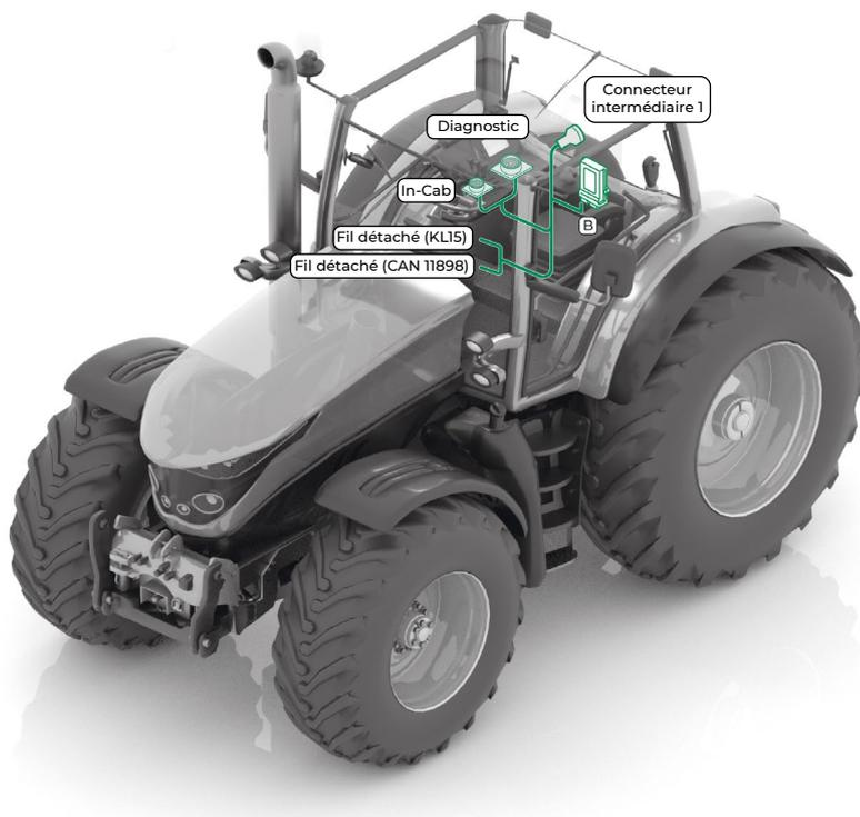
Image 12 : Installation du faisceau B de câbles
