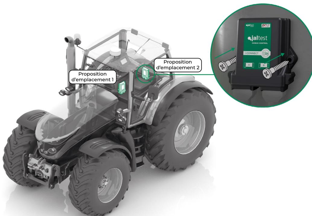
Image 5 : Proposition d'emplacement i-Connect et mode d'ancrage
