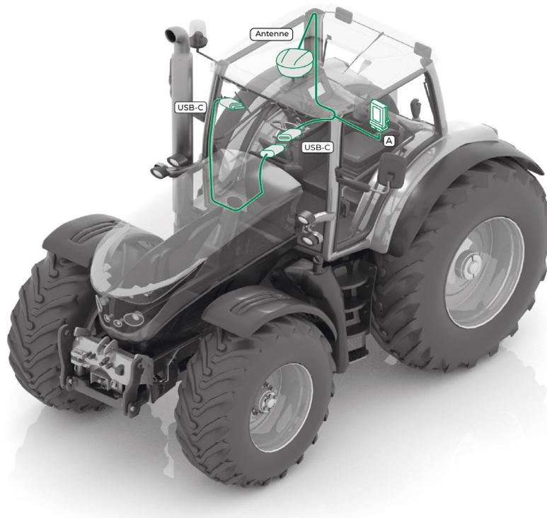
Image 22 : Installation du faisceau A de câbles
