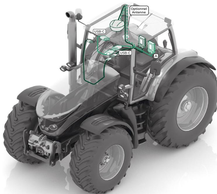
Image 26 : Installation du faisceau A de câbles combinaison Kit Jaltest i-Connect Standard et Kit Jaltest i-Connect - Personnalisé 1 combinés
