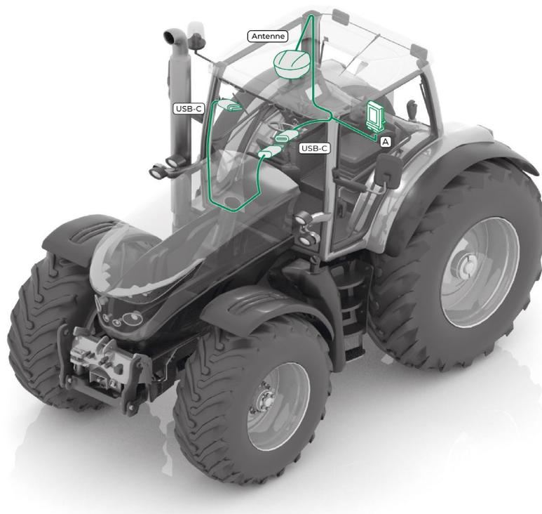
Image 14 : Installation du faisceau A de câbles
