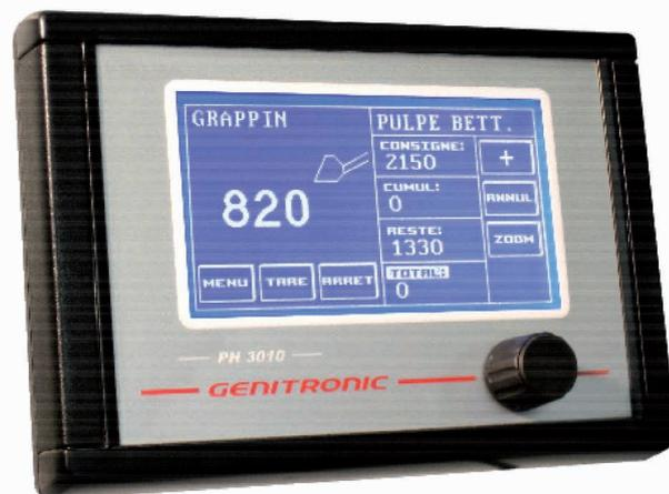
Le nouveau système de pesage PH 3010 CF2 utilise la mesure de la pression hydraulique générée par la charge levée dans les vérins du chargeur pour en calculer le poids. Pour une meilleure précision, le PH3010 CF2 utilise une méthode basée sur la mesure de pression différentielle des vérins de levage au moyen de 2 capteurs de pression installés sur la montée et la descente
