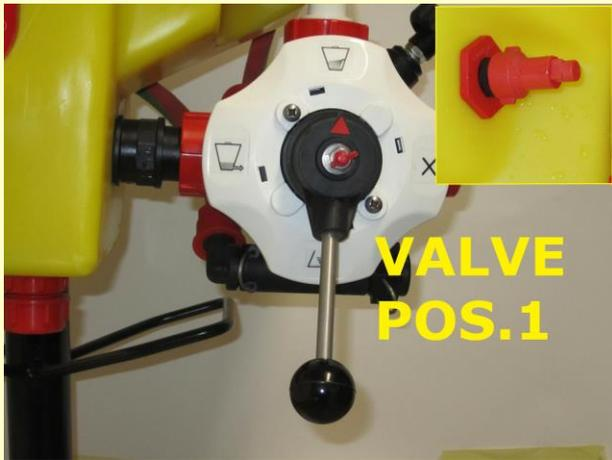
POS.1=Mélange du produit et remplissage de la cuve (actionnement buse ROUGE).
