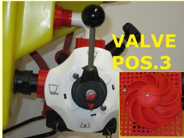
POS.3=Mélange du produit et remplissage de la cuve (actionnement buse rouge).
