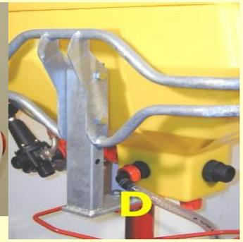
A=Alimentation de 80÷100 lt/min B=Décharge pression excédante C=Refoulement dans la cuve.
