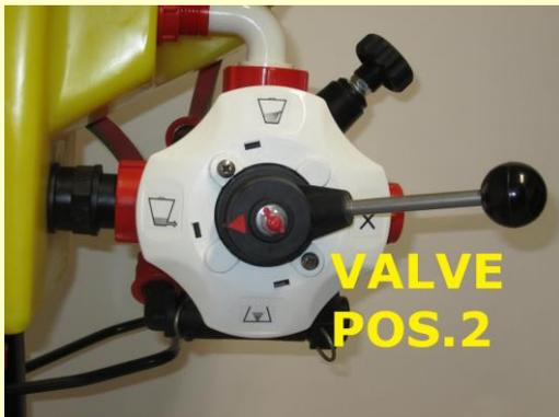
POS.2=Dévissement de la cuve du produit précédemment mélangé parmi le système Venturi (C=refoulement dans la cuve).
