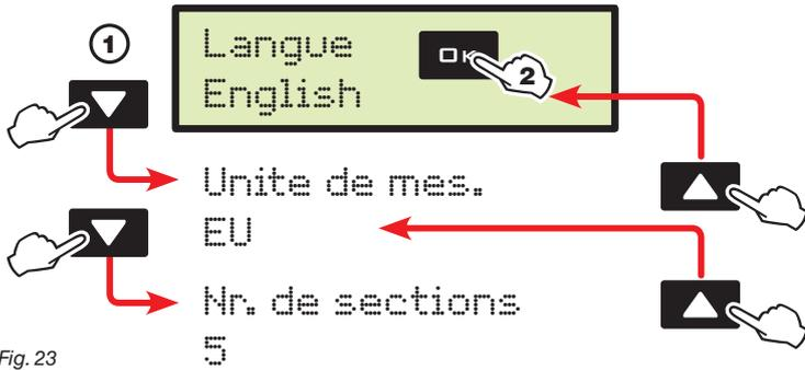
1 Appuyez en séquence sur les touches flèche pour vous déplacer entre les rubriques de menu (▼ rubrique suivante, ▲ rubrique précédente) ; la rubrique sélectionnée sera affichée (Fig. 23).
