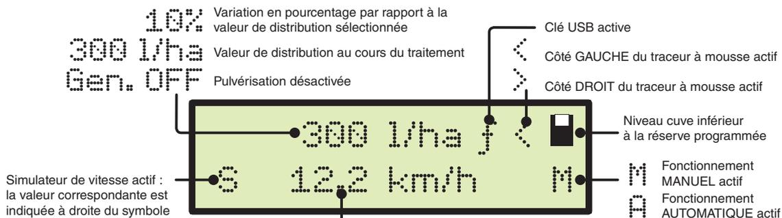
Données de fonctionnement affichées au cours du traitement : Vitesse, Pression, Débit, Surface, Liquide pulvérisé, Liq. dans cuve, Temps, Distance
