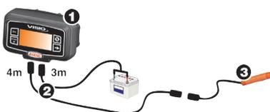
Montage avec 2 capteurs
