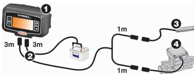
Livré avec 2 capteurs de vitesse inductifs et 1 kit faisceaux alimentation et capteurs
