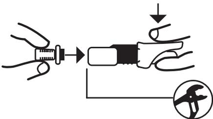
Maintenez avec vos doigts les 4 mors fermement sur le boulon-guide et remplacez celui-ci sur l'agrafe. Resserrez avec des tenailles.
