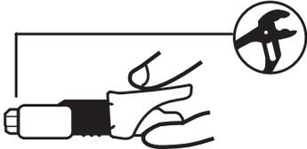
Utilisez les tenailles pour maintenir le boulon-guide et tourner dans le sens inverse des aiguilles d'une montre pour le défaire.
