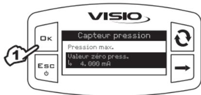
1) Accédez au réglage de la valeur zéro du capteur de pression (Menu principal > Capteurs > Capteur pression > Valeur zéro press.).
