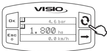
Pour mettre à zéro un totalisateur, il est nécessaire de l'afficher en mode étendu. Pour ce faire, appuyez à plusieurs reprises sur la touche jusqu'à ce que la valeur à remettre à zéro se trouve dans la section centrale de l'écran.
