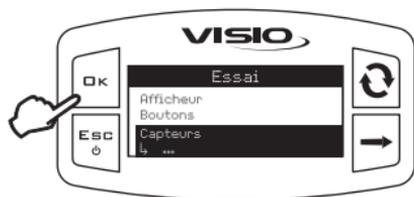
Accédez au menu du test des capteurs (Menu principal > Essai > Capteurs).
