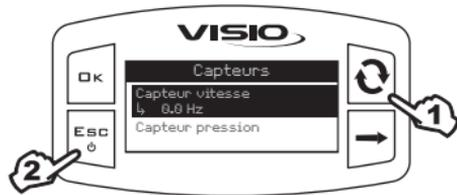
Sous la rubrique sélectionnée, l'écran affiche la valeur actuellement mesurée par le capteur.
