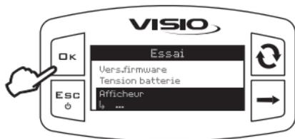
1) Accédez au menu du test de l'afficheur (Menu principal > Essai > Afficheur).
