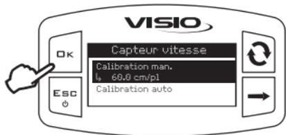
1) Accédez au menu de calibration manuel (Menu principal > Capteurs > Capteur de vitesse > Calibration man.).
