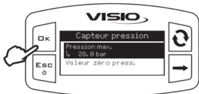
1) Accédez au réglage de la pression maximale du capteur (Menu principal > Capteurs > Capteur pression > Pression max).
