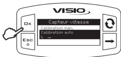
1) Accédez au menu de calibrage automatique (Menu principal > Capteurs > Capteur de vitesse > Calibration auto).
